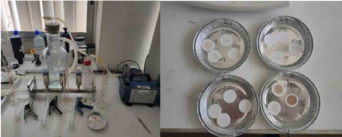
Figura 3.3. Filtrado para la determinación de sólidos en suspensión.
