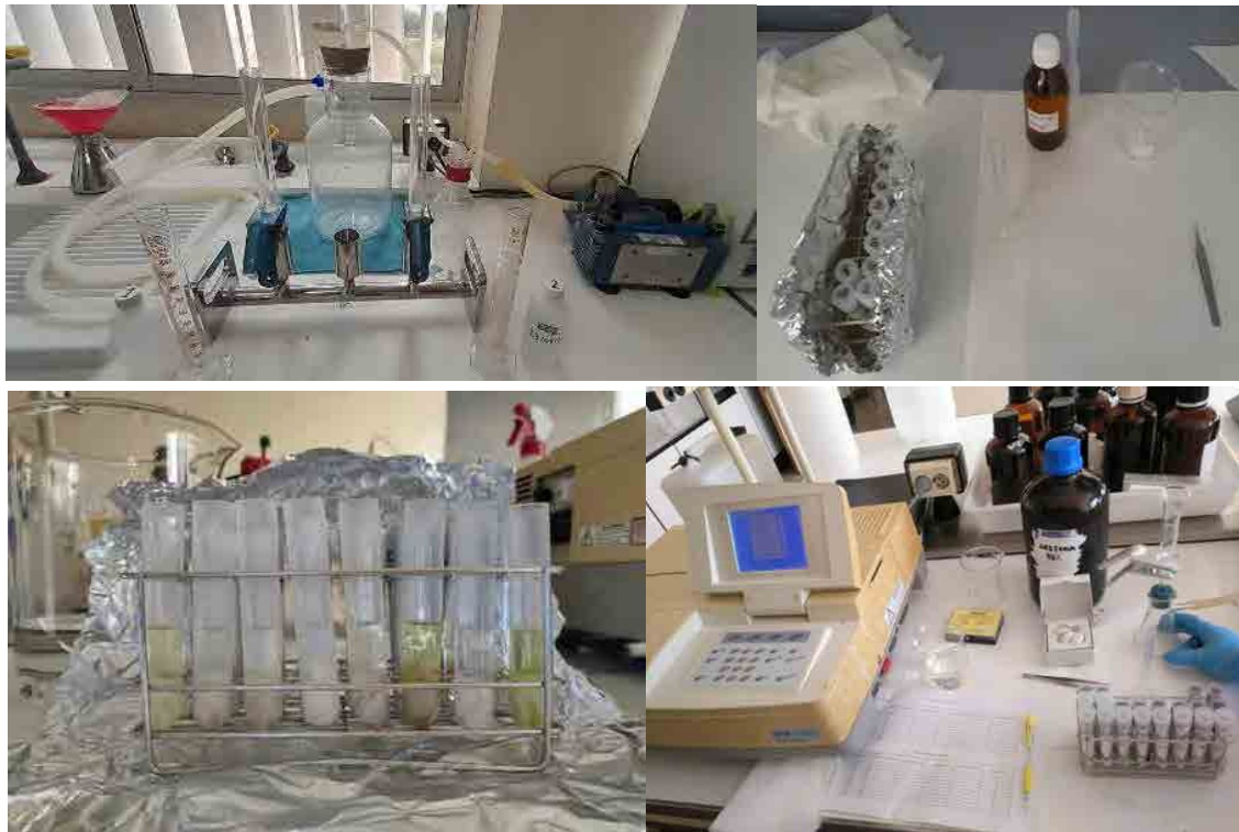
Figura 3.4. Distintas fases del proceso de análisis de pigmentos: Filtrado de las muestras, extracción de pigmentos con acetona y medición de absorbancia con espectrofotómetro.
