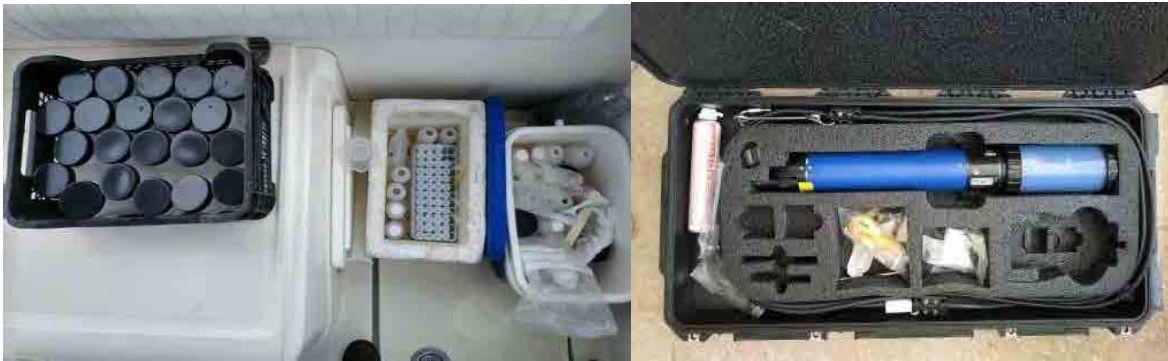
Figura 3.2. Materiales necesarios y sonda multiparamétrica YSI EXO2, empleados en las campañas de campo para la toma de datos y muestras en la columna de agua.
