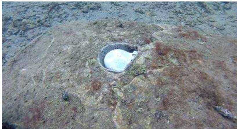
Figura 2. Ejemplo de fondeo de ADCP sobre el lecho en el canal de Marchamalo.
