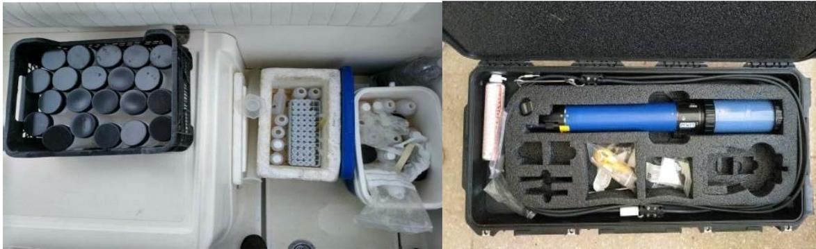
Figura 3.2. Materiales necesarios y sonda multiparamétrica YSI EXO2, empleados en las campañas de campo para la toma de datos y muestras en la columna de agua.
