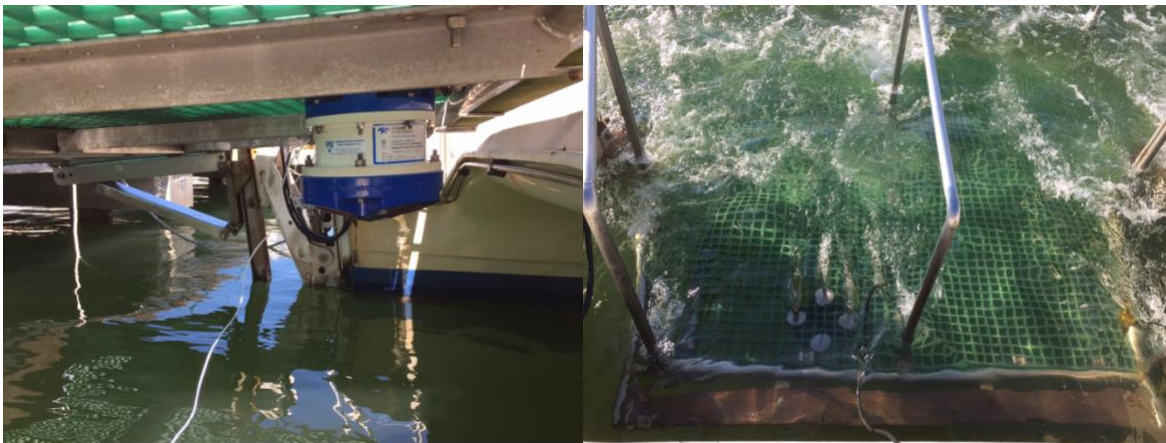
Figura 3.- ADCP 1200 KHz ubicado en la plataforma sumergible de popa del buque “DeepCore” de Rivermar S.L.
