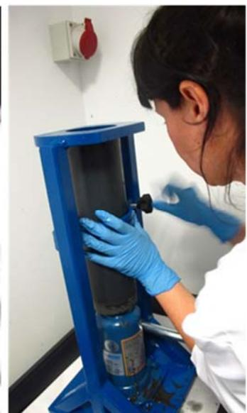
Fotografías 16, 17 y 18. Colocación de los testigos en vertical en el eyector de muestras (consistente en un gato hidráulico acoplado a un soporte fabricado en el taller del SAIT-UPCT).
