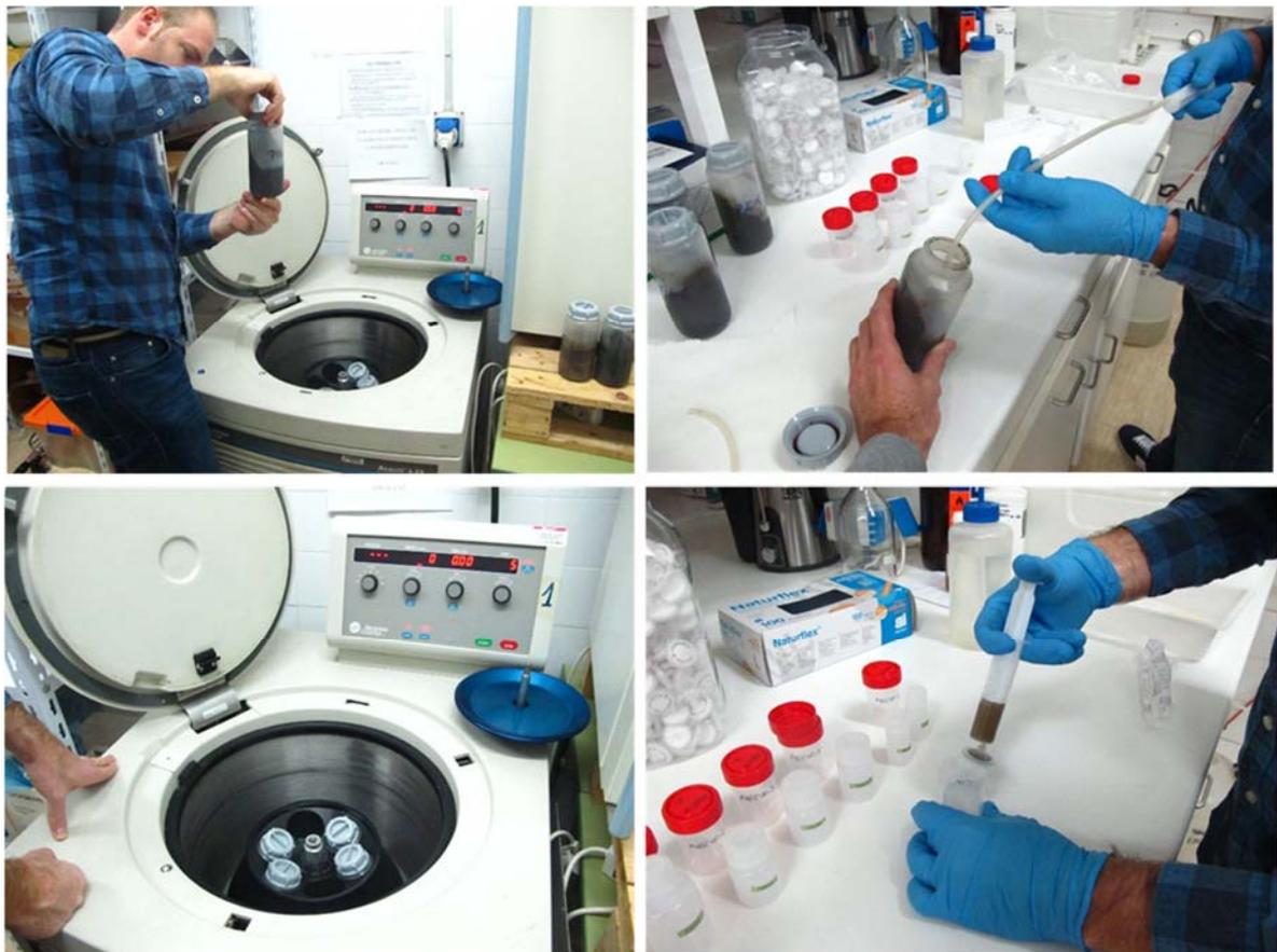
Fotografías 25, 26, 27 y 28. Centrifugado y filtrado del agua intersticial a través de filtro de nylon de 0,45 µm de diámetro de poro.
