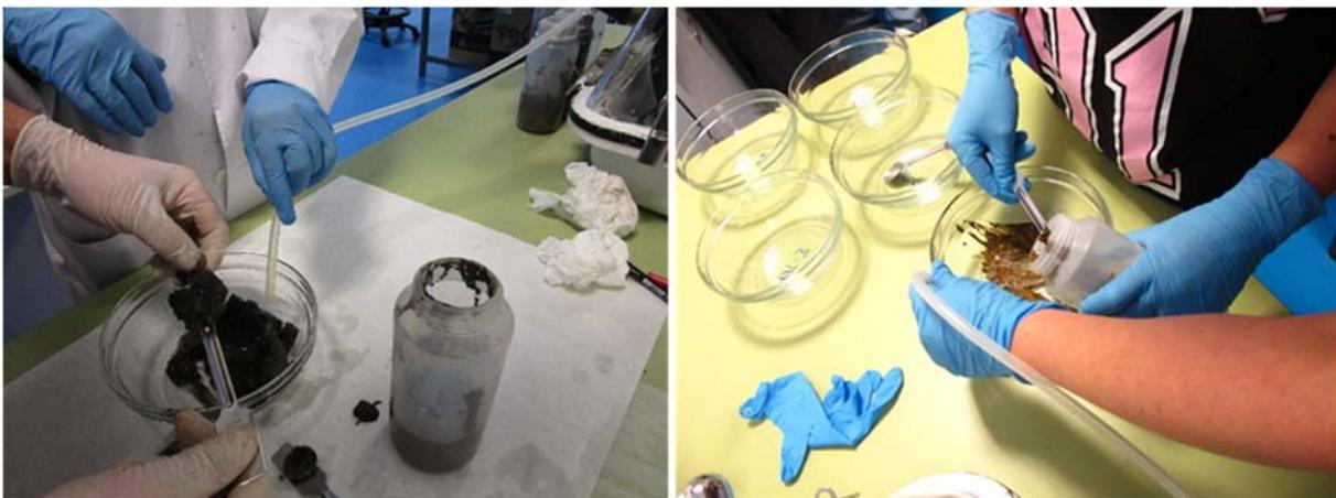
Fotografías 21 y 22. Colocación de las muestras en los tubos de centrifuga insuflando  $N_2$  para evitar oxidaciones del material.
