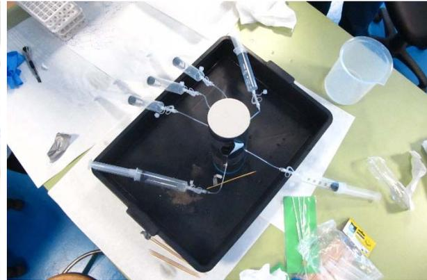
Fotografías 29, 30, 31 y 32. Extracción del agua intersticial en los testigos arenosos a diferentes profundidades utilizando muestreadores tipo Rhizon®.
