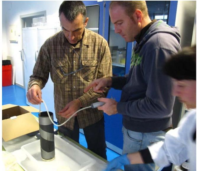
Fotografías 14 y 15. Extracción del agua sobrenadante de los testigos de sedimento.
