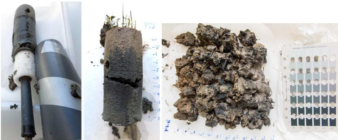
Fotografías 11, 12 y 13. Extracción de los testigos de sedimento de los tubos de PVC y determinación del color con la guía Munsell® Soil Colour Charts (1994).
