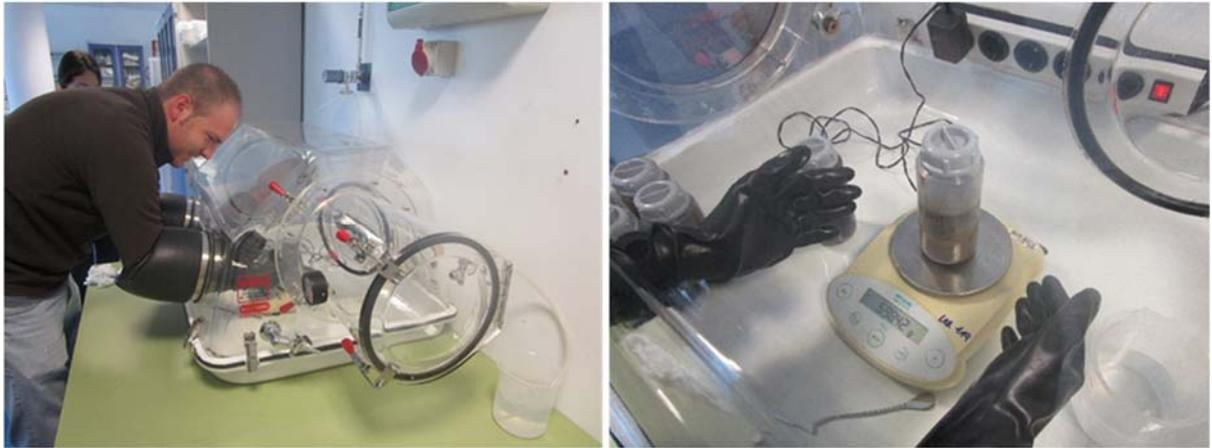
Fotografías 23 y 24. Ajuste de los pesos de los tubos de centrifuga en cámara con atmósfera de N<sub>2</sub>
