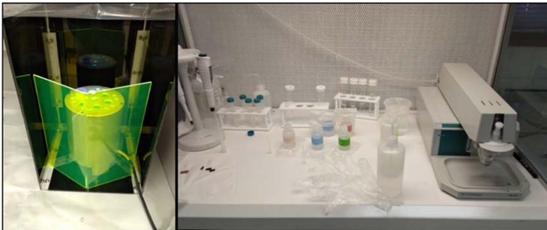
Fotografías 55 y 56. Sistema electroquímico (Metrohm 797 VA Computrace) y digestor ultravioleta para medida de metales en agua intersticial y agua de la columna.
