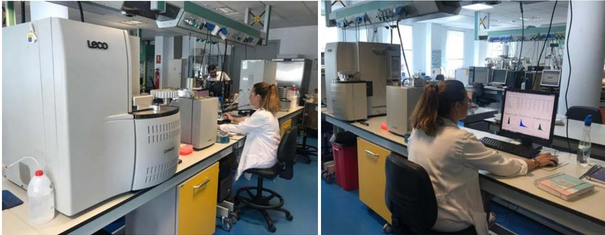
Fotografías 37 y 38. Análisis del COT,  $\text{CaCO}_3$  y NT en el analizador CHN 628 de Leco del Servicio de Apoyo a la Investigación Tecnológica de la UPCT (SAIT-UPCT)
