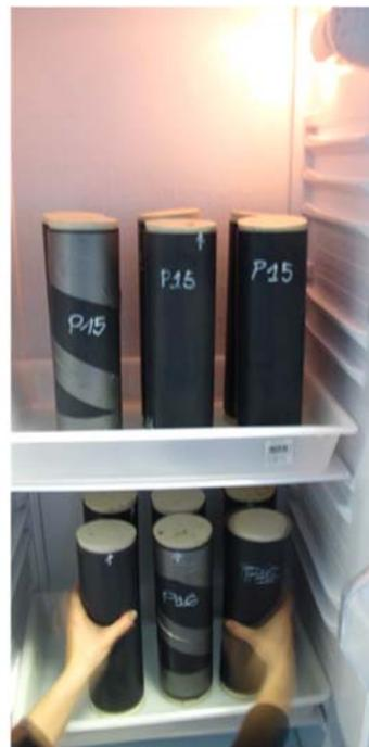
Fotografías 7 y 8. Transporte y almacenamiento de los testigos en el interior de neveras refrigeradas y frigorífico en posición vertical para evitar la mezcla del agua intersticial.
