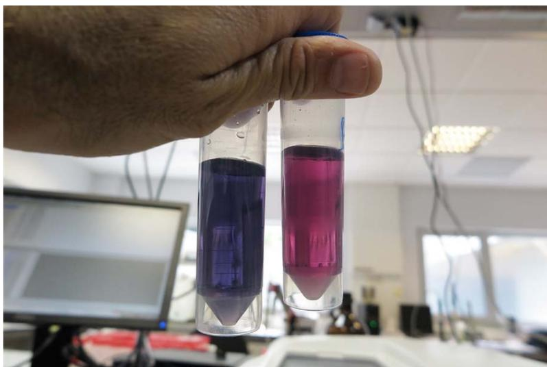
Fotografía 47. Aspecto de las muestras para la determinación colorimétrica de los AVS extraídos.
