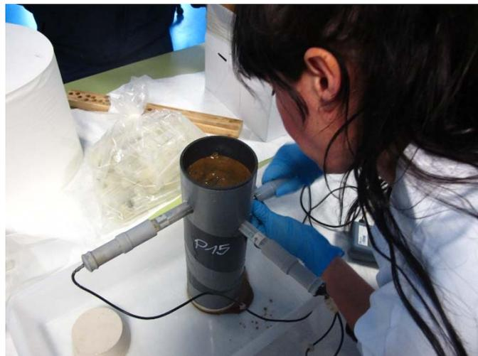
Fotografías 3 y 4. Tubos con agujeros tapados con cinta americana e inserción de electrodos de pH/Eh
