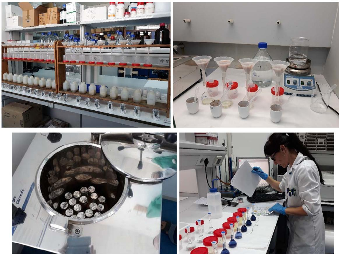
Fotografías 40, 41, 42, 43. Diferentes etapas del procedimiento de fraccionamiento del fósforo en las muestras de sedimento.
