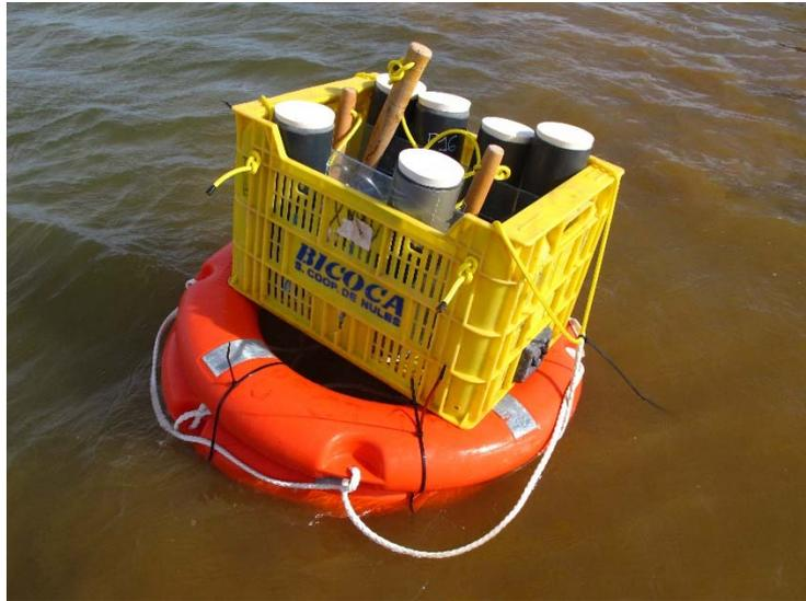
Fotografías 1 y 2. Aspecto de los tubos de PVC utilizados en el muestro de testigos
