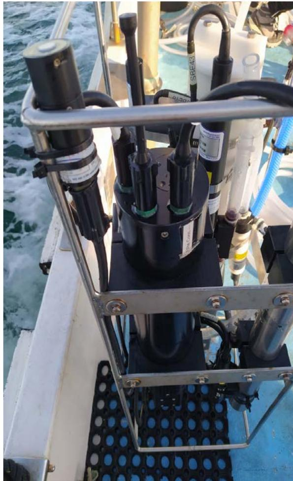
Figura 153. Fluorómetro de Inducción y Relajación utilizado en este trabajo.
