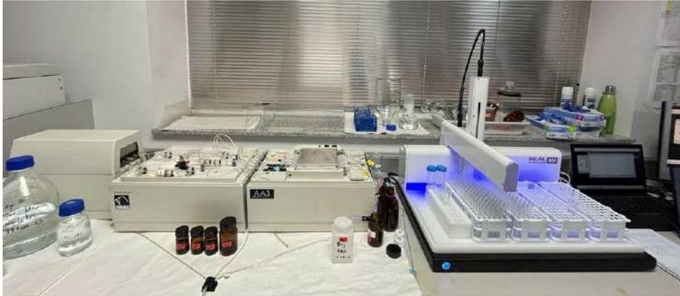
Figura 143. Autoanalizador de flujo segmentado AA3 (Seal Analytical)
